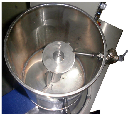
Cuba de mezcla - Mixing tank
