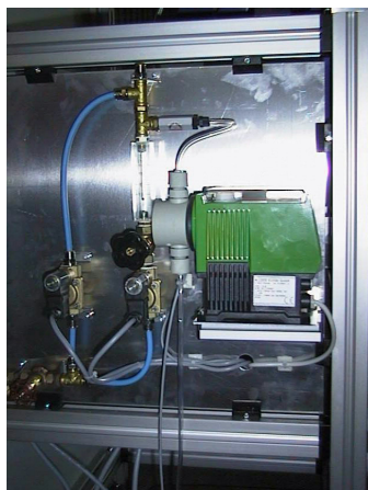
Sistema de dosificación automático de pasta de esmerilar mezclándola con agua.
